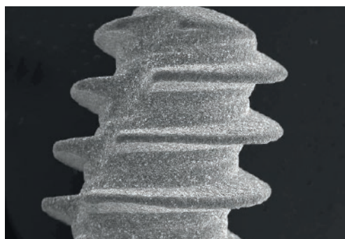
Figura 2: imagen 20X con visualización de zona apical de la superficie tratada de la muestra.
